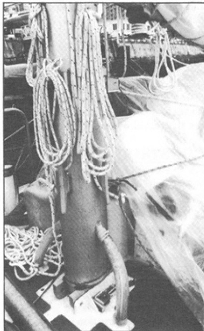
Photo D 68 : Passage des fils électriques vers le pied de mât.
